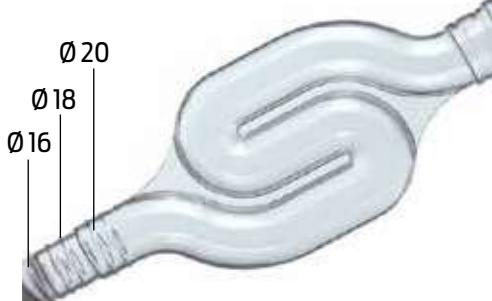
Il sifone è stato realizzato per evitare il ritorno dei cattivi odori provenienti dal tubo di scarico condensa. Semplice e funzionale, può essere agevolmente collegato a tutti i tubi di scarico. In PVC rigido trasparente per consentirne rapida ispezione. Grazie alle sue contenute dimensioni può essere collocato anche in canalina.
