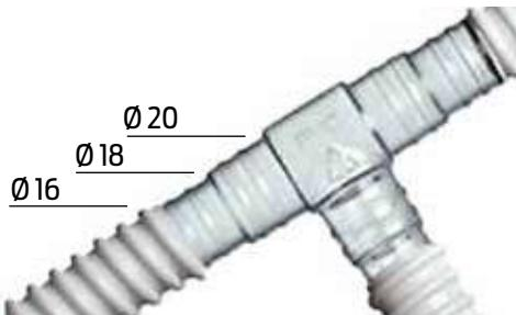
Il giunto a "T" è utilizzato per derivare il tubo scarico condensa. Utilizzabile con tubi spiralati Ø16, Ø18, Ø20 e con tubi corrugati Ø16 e Ø20.
