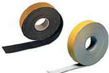
I nastri anti-condensa sono prodotti in gomma sintetica espansa a cellule chiuse. Colore nero o bianco e spessore 3mm. Reazione al fuoco: B-s3, d0 (EN13501).
