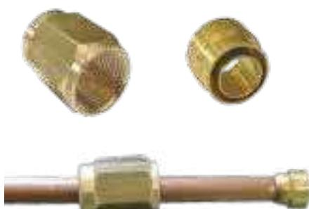
Raccordi autocartellanti in ottone per sistemi split; sostituisce la cartellatura e non necessita di alcuna saldatura; l'ogiva si adatta automaticamente al tubo sia con spessore 0,8 che con spessore 1 mm.
