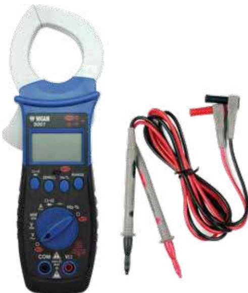
Strumento per la misurazione di Ampere AC, Ampere DC, Volt AC, Volt DC e Ohm, indicazione digitale, display retroilluminato, 2000 punti di lettura, misure di conduttori Ø 30, prova di continuità con segnalazione acustica, memoria, autospegnimento, prova diodi.
